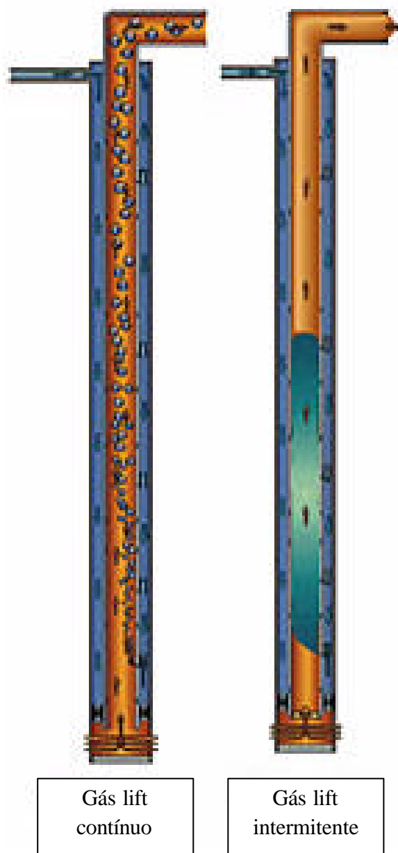
FIGURA 2: Esquema de Gás Lift contínuo e intermitente. Fonte: (Weatherford, 2006).
